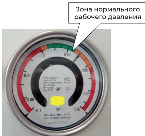
Рис. 3-4 Датчик давления
